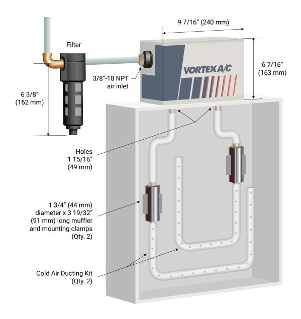
SHOWN TOP MOUNTED ON CUSTOMER'S ENCLOSURE PURGE SYSTEM SHOWN FOR REFERENCE ONLY
