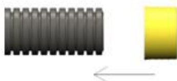
Abbildung 5.8.2.4: Gelbe Dichtring über den Schutzschlauch
