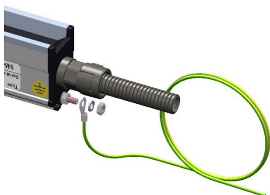
Image 5.8.1.1 : Raccordement à la terre
